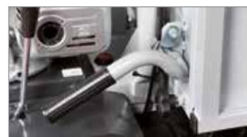
Ribaltamento manuale con sistema di bloccaggio automatico.
